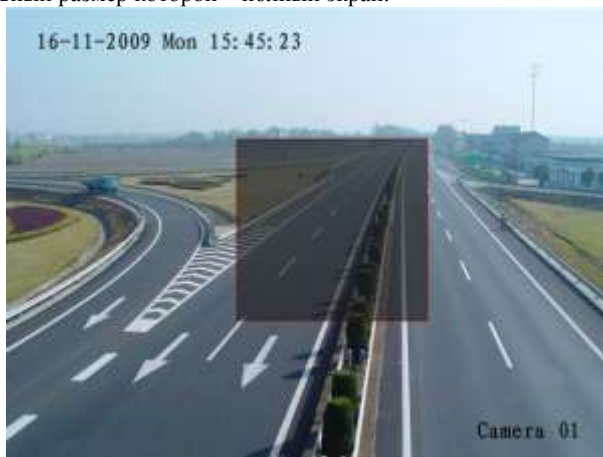
Рис. 14. Настройка зоны определения подделки видео.
