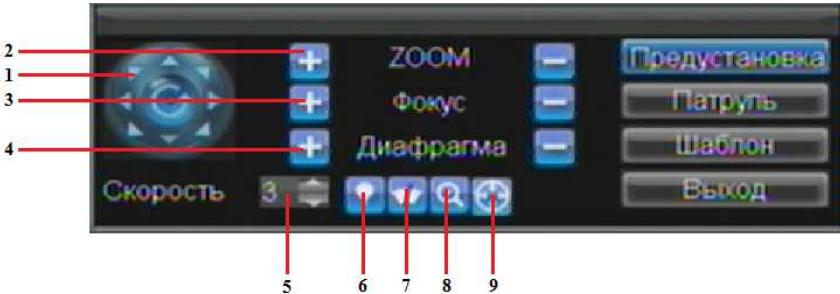
Рис. 3. Интерфейс управления устройствами PTZ
