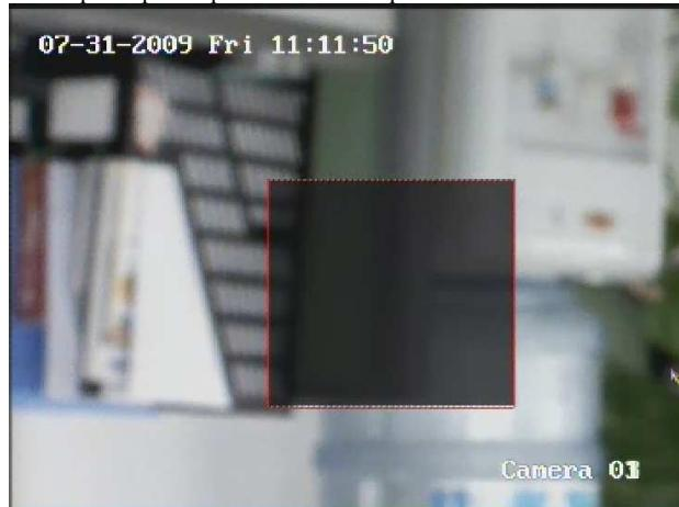
Рис. 14. Настройка зоны определения подделки видео.
