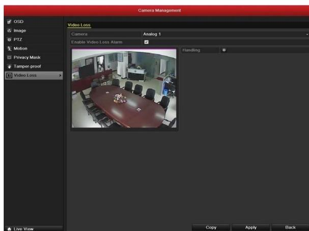
Рисунок 8.7 Установка метода управления сигналом потери видео
