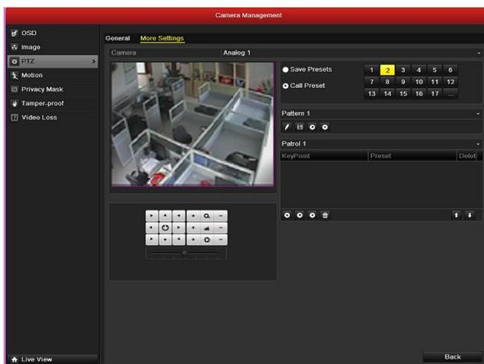
Рис 4.4 PTZ- вызов предварительно настроенного участка (предустановки)
