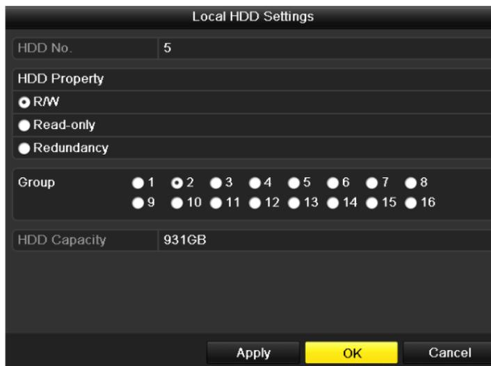
Рисунок 10.11 Интерфейс локальных настроек жесткого диска
