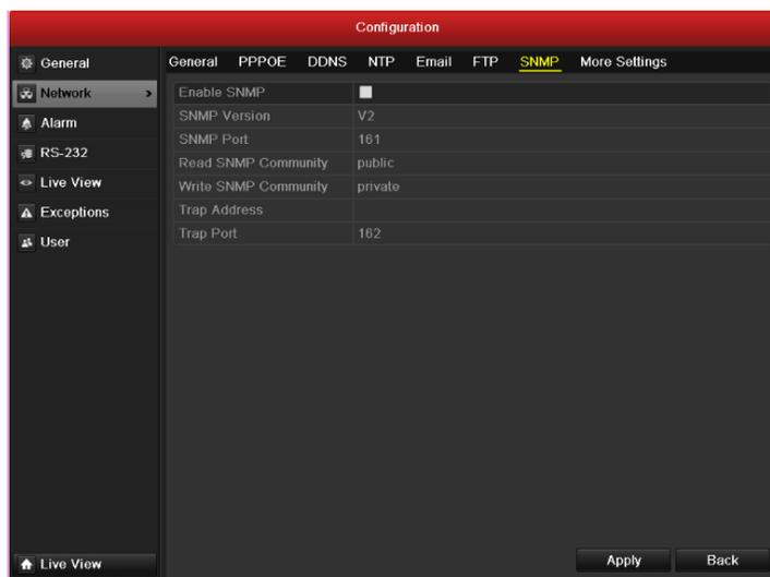
Рисунок 9.9 Интерфейс конфигурации SNMP
