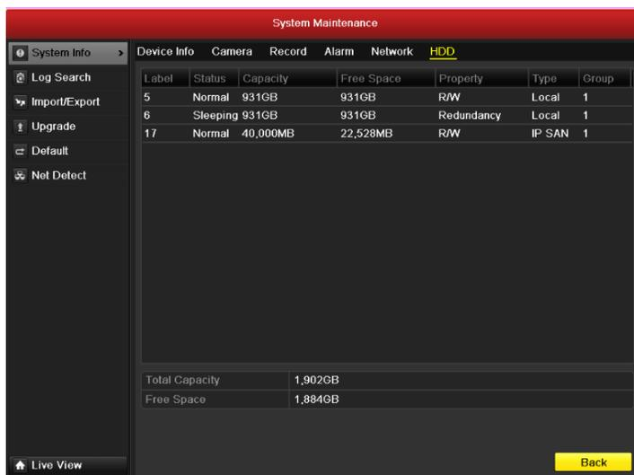
Рисунок 10.19 Проверка статуса HDD (2)
