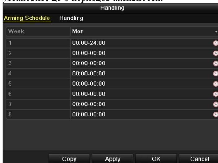
Рисунок 8.8 Установка расписания реакции на заслон объектива
