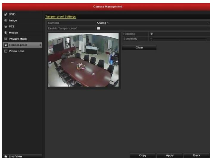
Рисунок 8.6 Интерфейс настройки детекции заслона обзора
