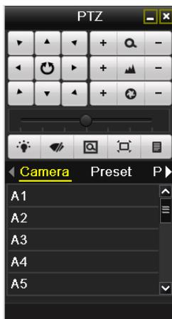
Рис 4.5 Панель инструментов PTZ
