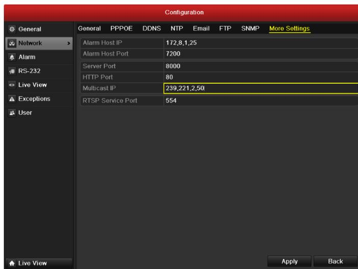
Рисунок 9.13 Конфигурация мультикаста
