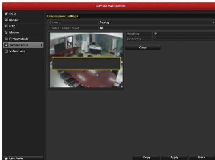
Рисунок 8.7 Установка зоны и чувствительности детекции заслона обзора
