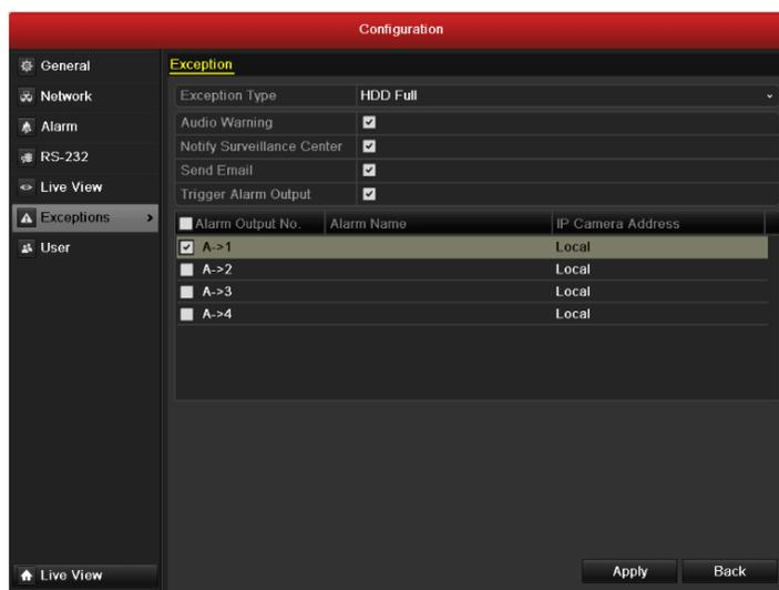
Рисунок 10.18 Конфигурация тревоги ошибок HDD
