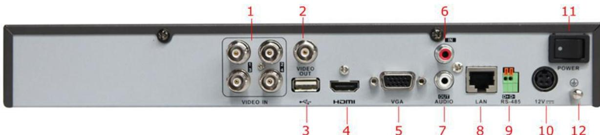
Рисунок 1.4 Задняя панель DS-7204HVI-SH/HFI-SH
