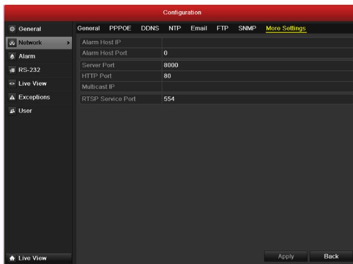
Рисунок 9.14 Интерфейс конфигурации RTSP
