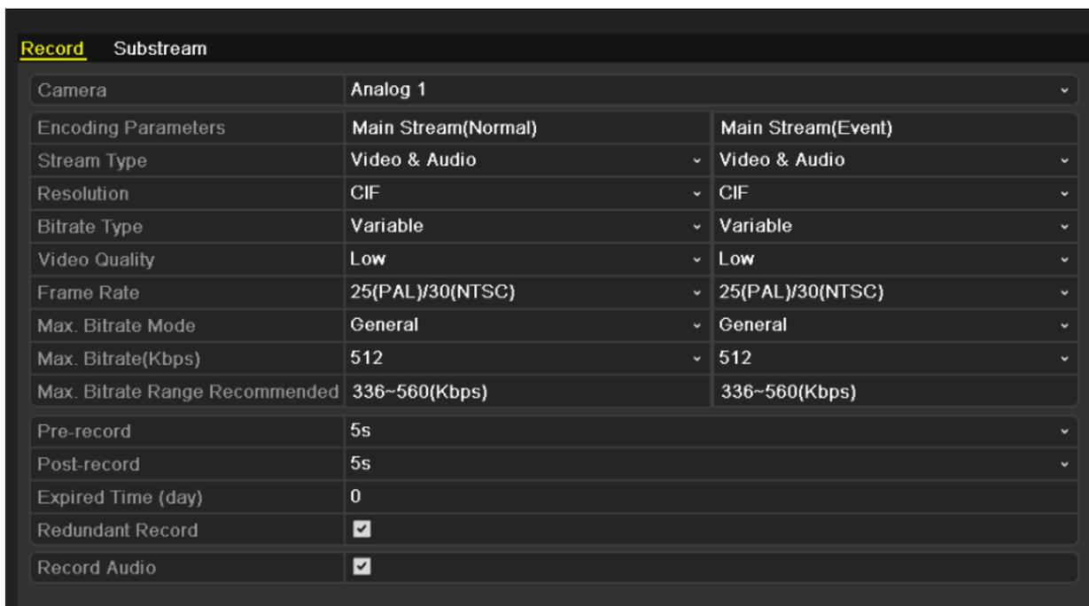
Рисунок 5.3 Раздел меню Record Encoding (параметры записи)
