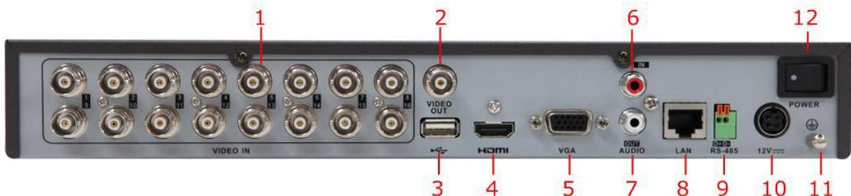
Рисунок 1.5 Задняя панель DS-7216HVI-SH
