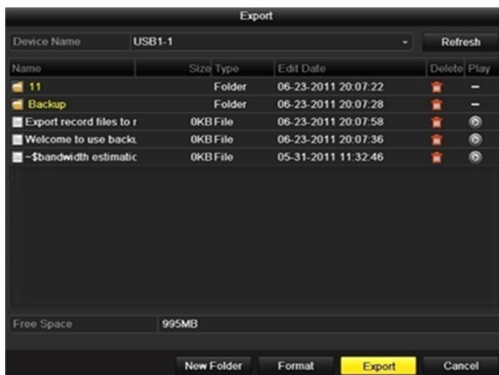
Рисунок 7.11 Экспорт видеоклипов с использованием USB Flash Drive
