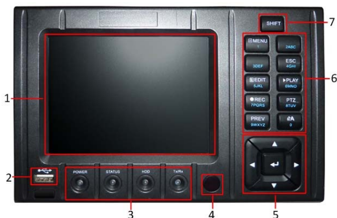
Рис. 11. Передняя панель DS-7204HVI-ST/L
