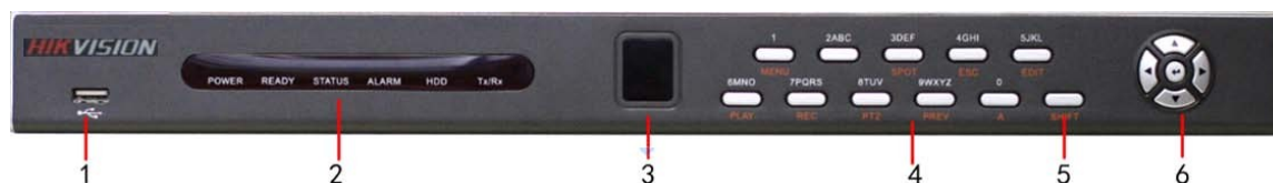
Рис. 8. Передняя панель DS-7208HVI-ST
