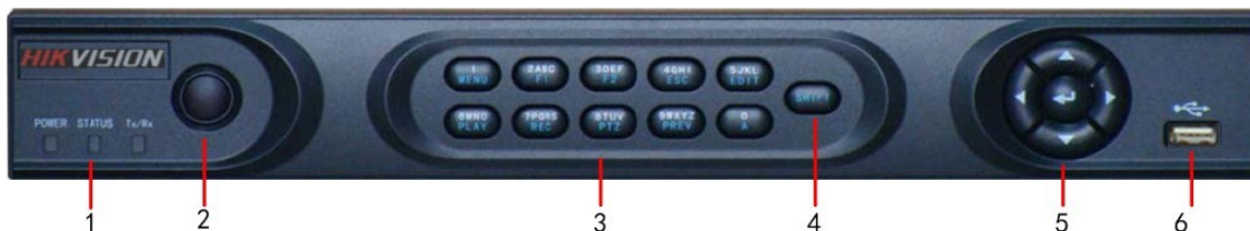
Рис. 7. Передняя панель DS-7204HVI-ST
