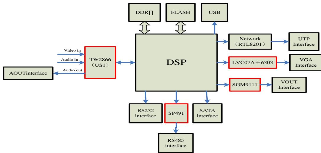
Diagram1.1 DS80054 Hardware Principle Diagram
